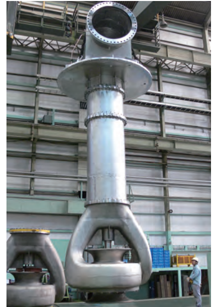
φ 1200 Brine recirculation pump (JEBEL ALI M, U.A.E.)
